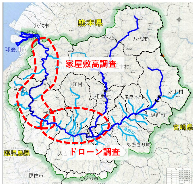
輪中堤・宅地かさ上げの設計・検討に向けた家屋敷高の測量状況 [球磨村]
