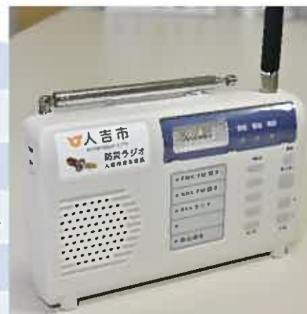
デジタル同報無線システム 整備工事(防災ラジオ整備) (人吉市)
