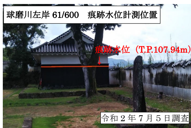
図 人吉大橋周辺における洪水痕跡水位計測状況
