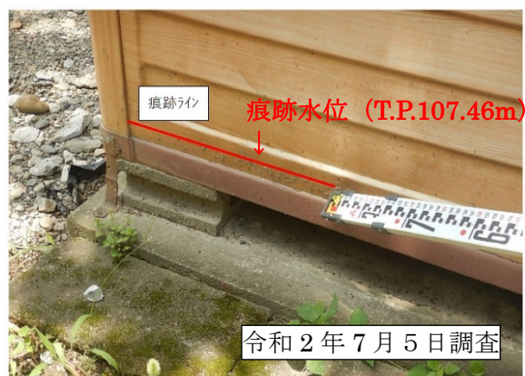
写真 球磨川左岸 61/400、61/600 洪水痕跡水位計測位置
