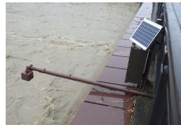
写真 23 出水直後の危機管理型水位計 (令和 2 年 7 月 14 日撮影)
