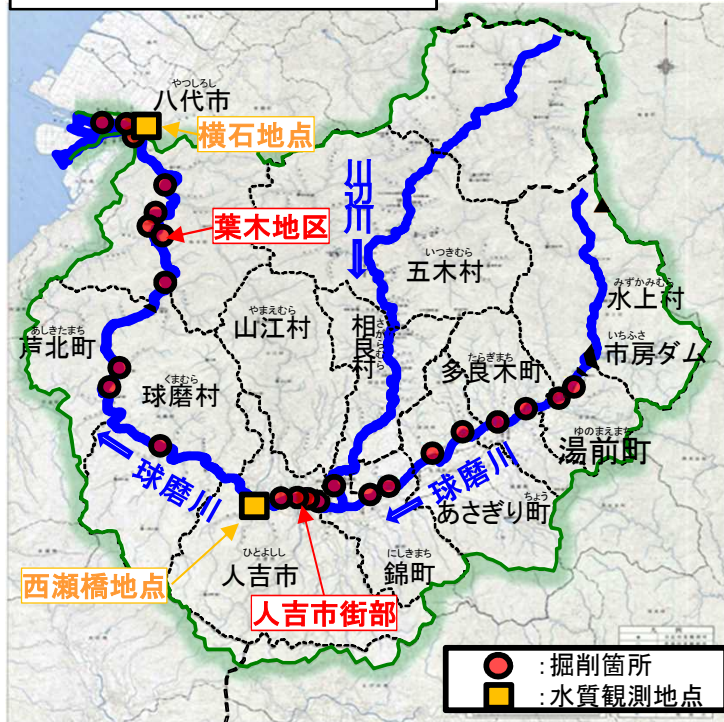
国管理区間における河道掘削位置
