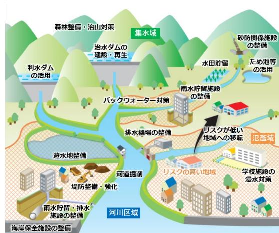
図 6.8 流域治水の施策イメージ図
