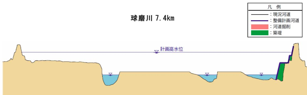
図 5.1 堤防整備横断図 (7.4km 付近 : 八代市萩原地区付近)
