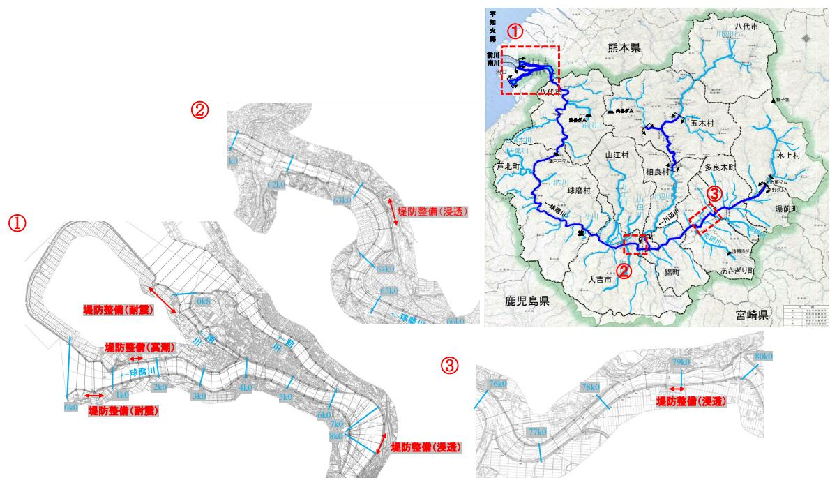
図 5.9 堤防の質的強化対策、高潮・耐震対策
