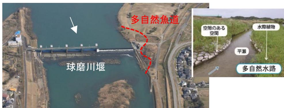
図 5.14 球磨川堰の多自然魚道の設置イメージ
