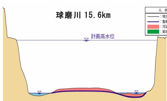
図 5.2 河道掘削横断図
