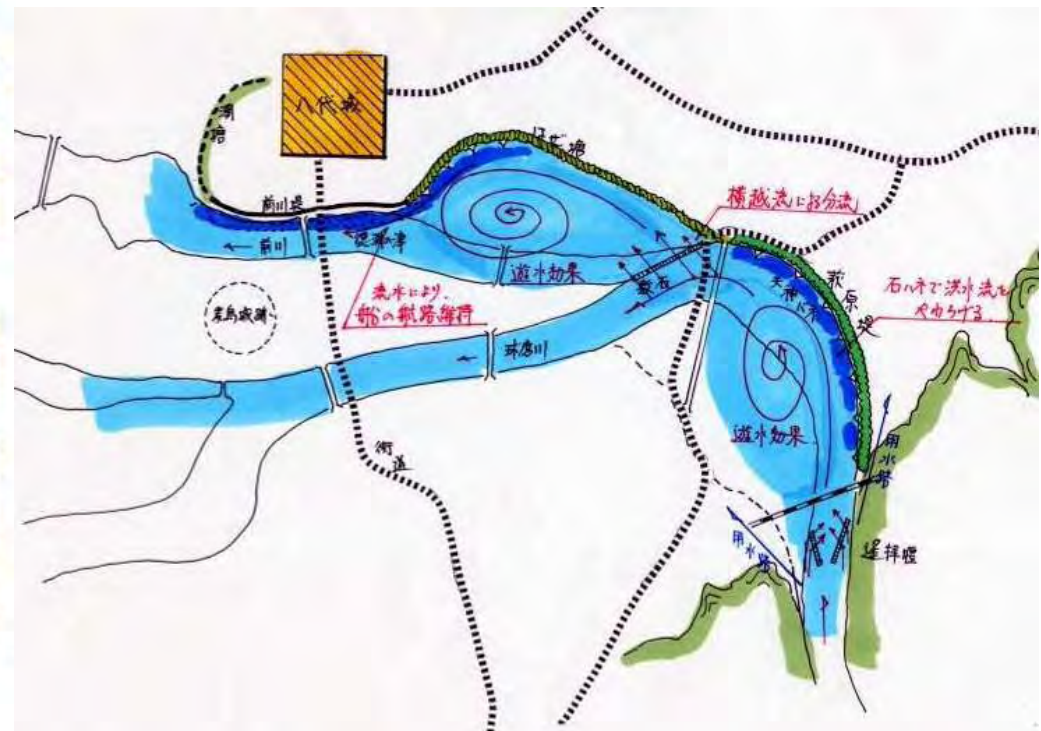
はね石：清正の巧みな治水技術として有名なはね石。清正は萩原堤の水衝部にこの石はねを設け、水の流れを流心に向かわせる工夫をした。
