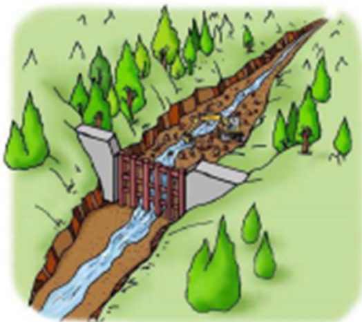
土石流捕捉イメージ図
