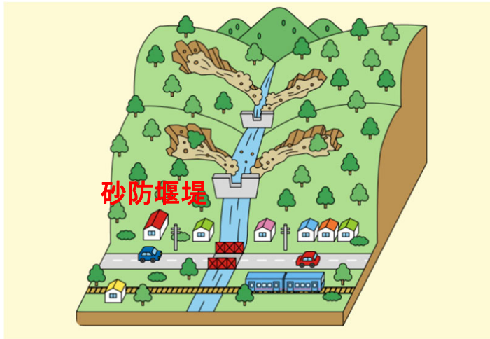
土石流捕捉イメージ図
