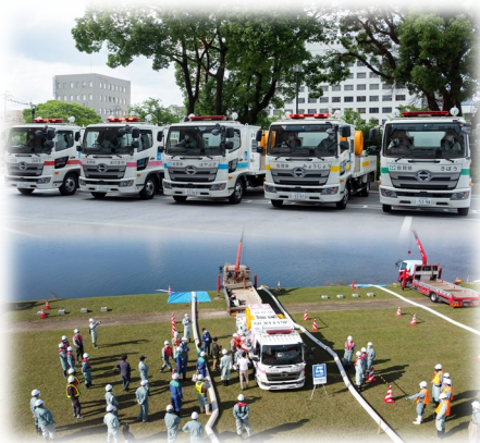
写真（上）- 排水ポンプ車
