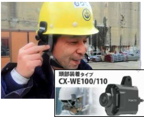
【機器装着状況】 (ヘッドホン+カメラ)
