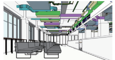
BIM を活用した品質確保、生産性向上(3次元での部材調整、検証)
