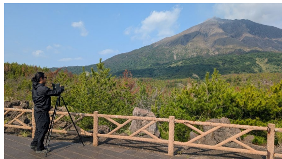
図10 3Dレーザースキャナーによる点群データの取得
