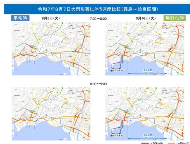
図-17 ETC2.0プローブデータによる速度比較図
