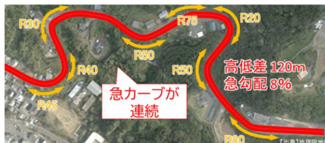
図-2-2 線形不良箇所(古江坂)
