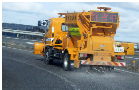
写真－8 湿潤式散布車の散布
