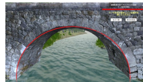
図-5 アーチ形状の変状が生じている状態と不可視部の洗掘のメカニズム
