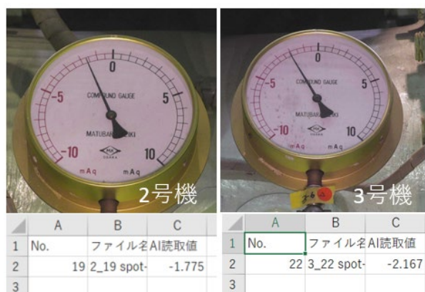
図-12 ロボットによる計器計測値読み取り
