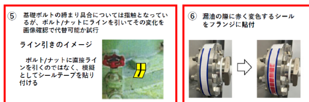
図-11 ボルトの緩みと油漏れの確認
