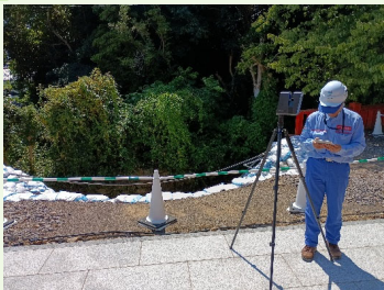
▲Matterport計測状況
