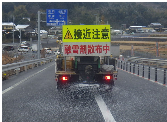
写真－3 乾式散布車の散布状況
