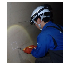
テストハンマーによる 打音調査
