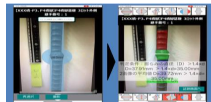
対象物を撮影 （撮影ガイド付き） 検査結果 （判定結果＋計測値） デジタル圧接継手外観検査（試行）
