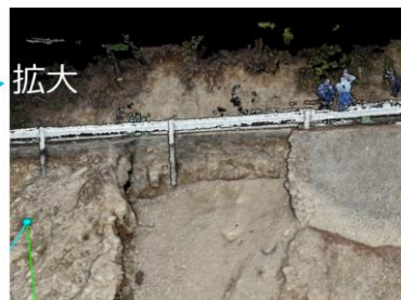
市販のドローンを用いた SfM測量結果
