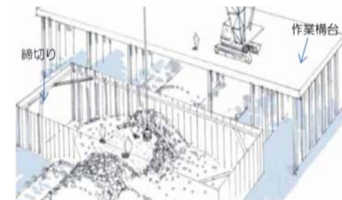
作業構台をして作業を実施
