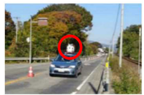
車載装置による路面性状測定
