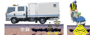
路面下空洞調査
