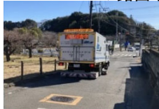
(空洞探査車による調査)
