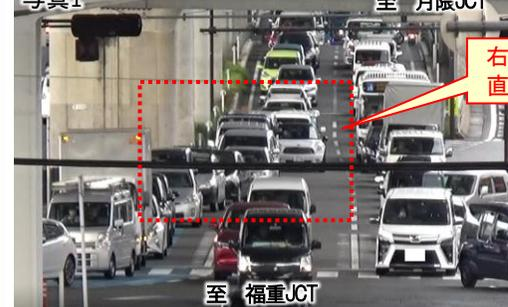
右折車両のみ出しによる直進車両の阻害が発生
