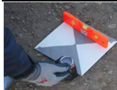
標高調整用基準点の一例
