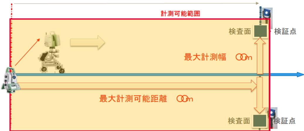
※標準反射板や反射シートなどは設置せず、計測面が露出した状態で計測すること
