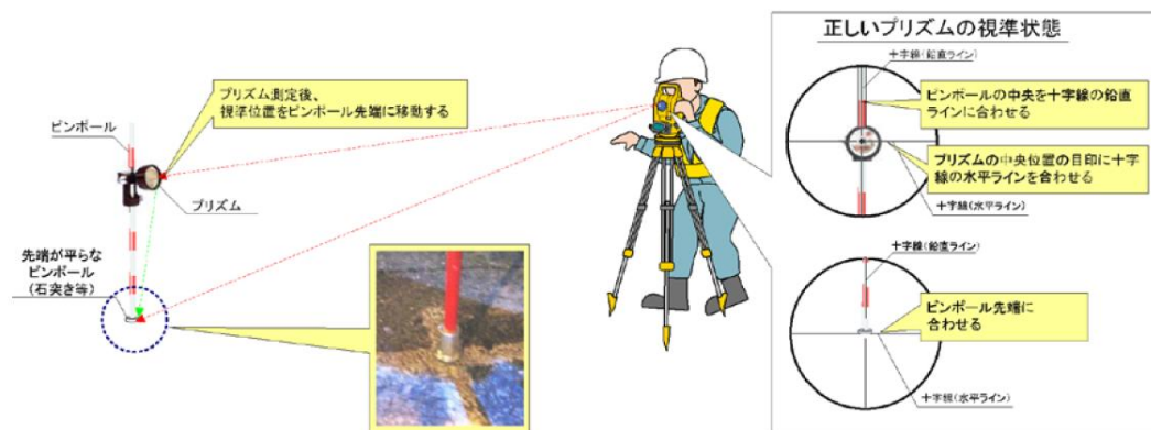
＜平面方向の精度確認方法＞
