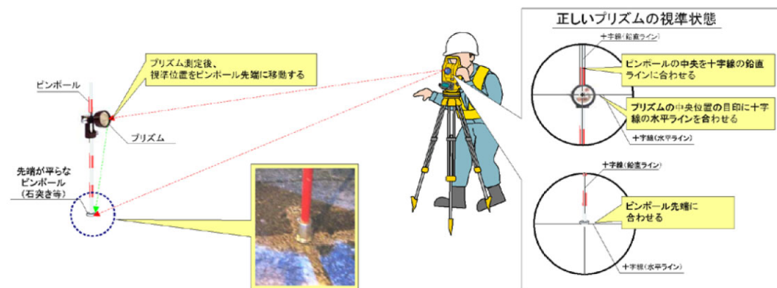
＜平面方向の精度確認方法＞
