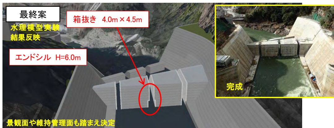
図 2.3.1.(11)-2 減勢工形状検討で活用した比較検討用モデル（視点場：ダム天端下流）
