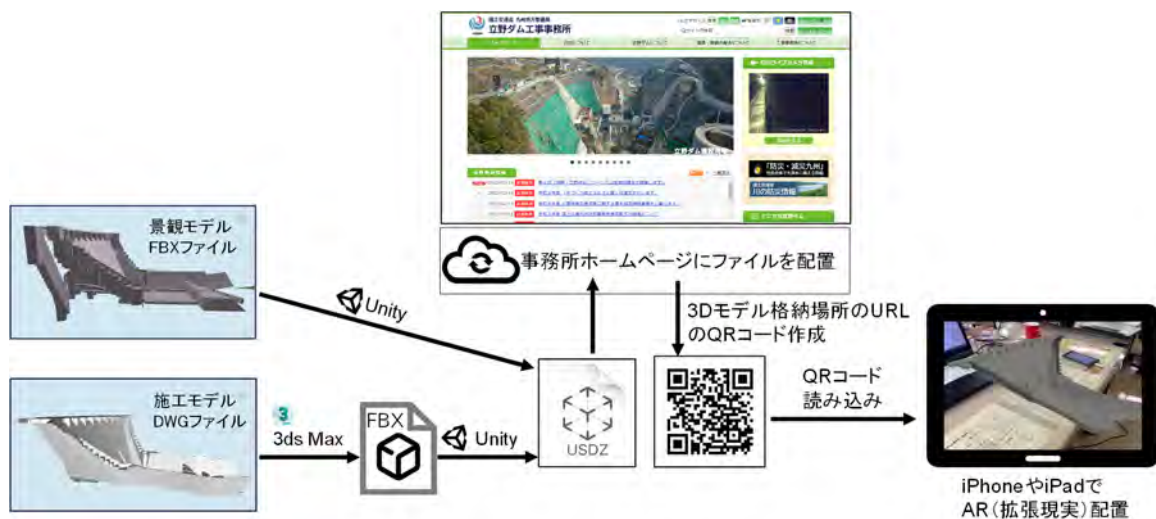
図 2.2.2.(2)-4 AR モデルの作成～公開までのワークフロー
