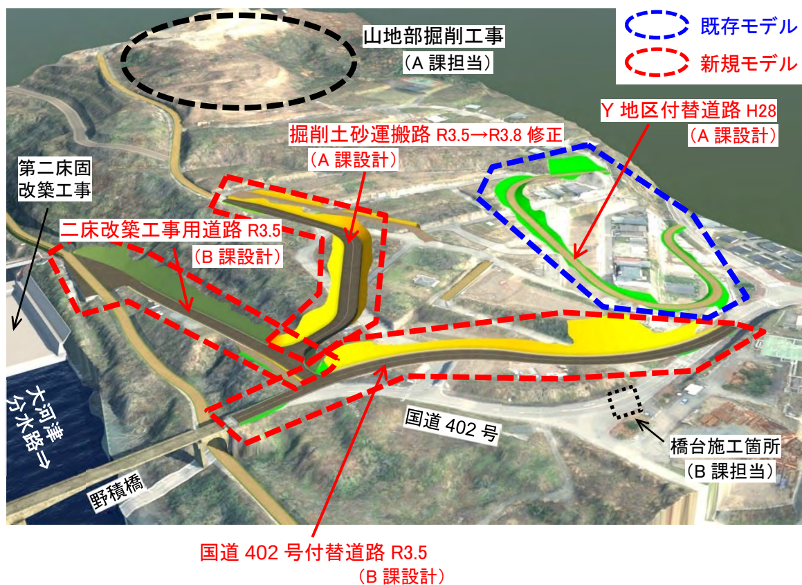
図 2.3.1.(4)-1 複数工事の実施可能性の確認において活用する検討用モデル
