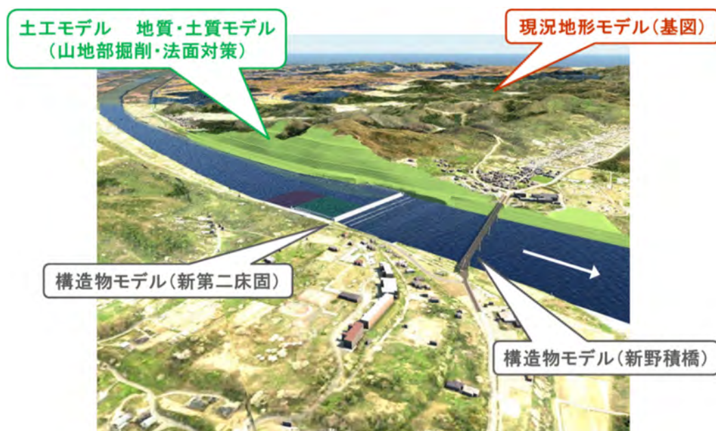
図 1.1-1 統合モデル（信濃川河川事務所の例）
