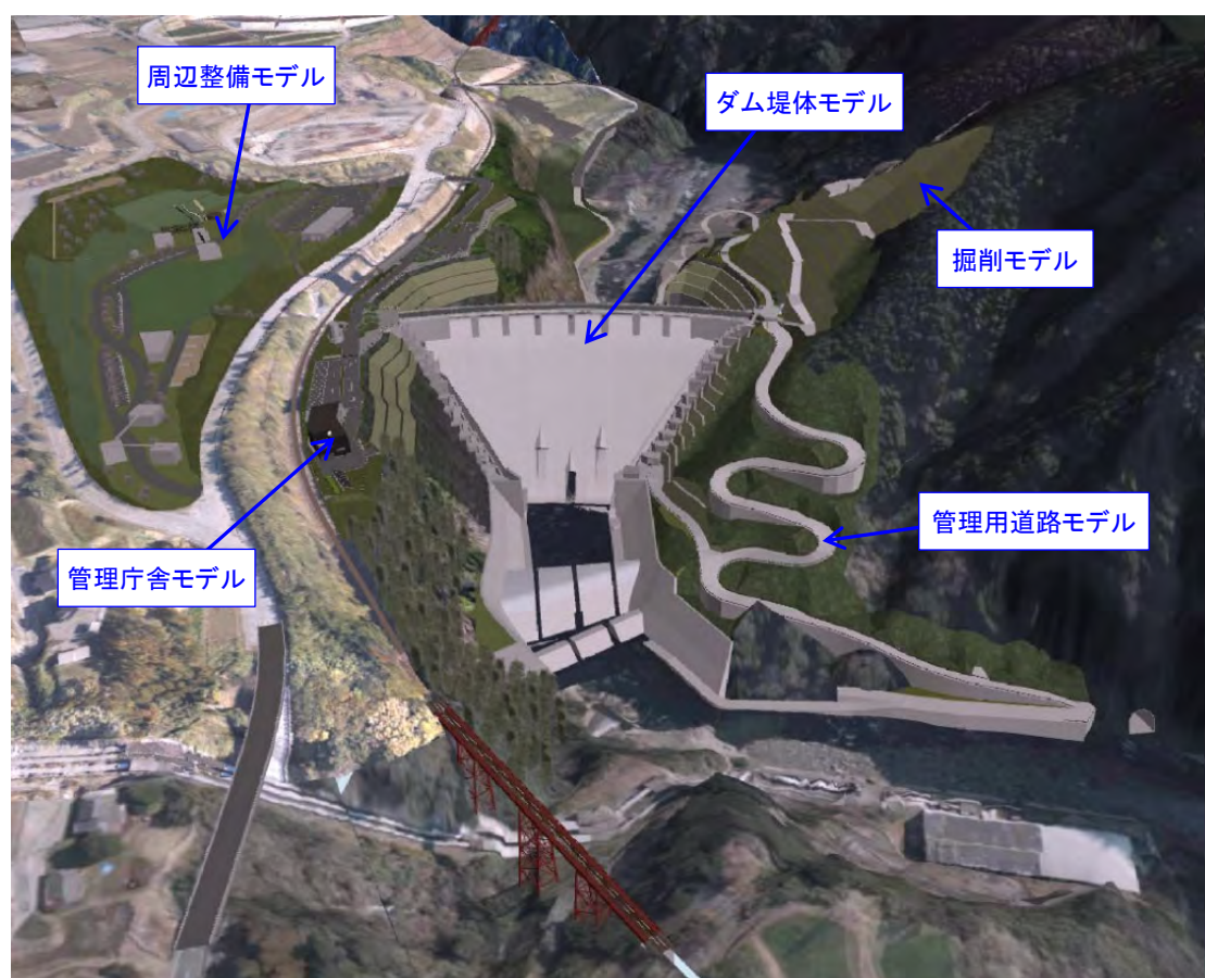
図 2.3.1.(10)-1 景観検討用の統合モデルの例
