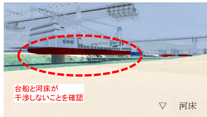
図 2.3.1.(2)-3 河床部干渉シミュレーション図（台船）
