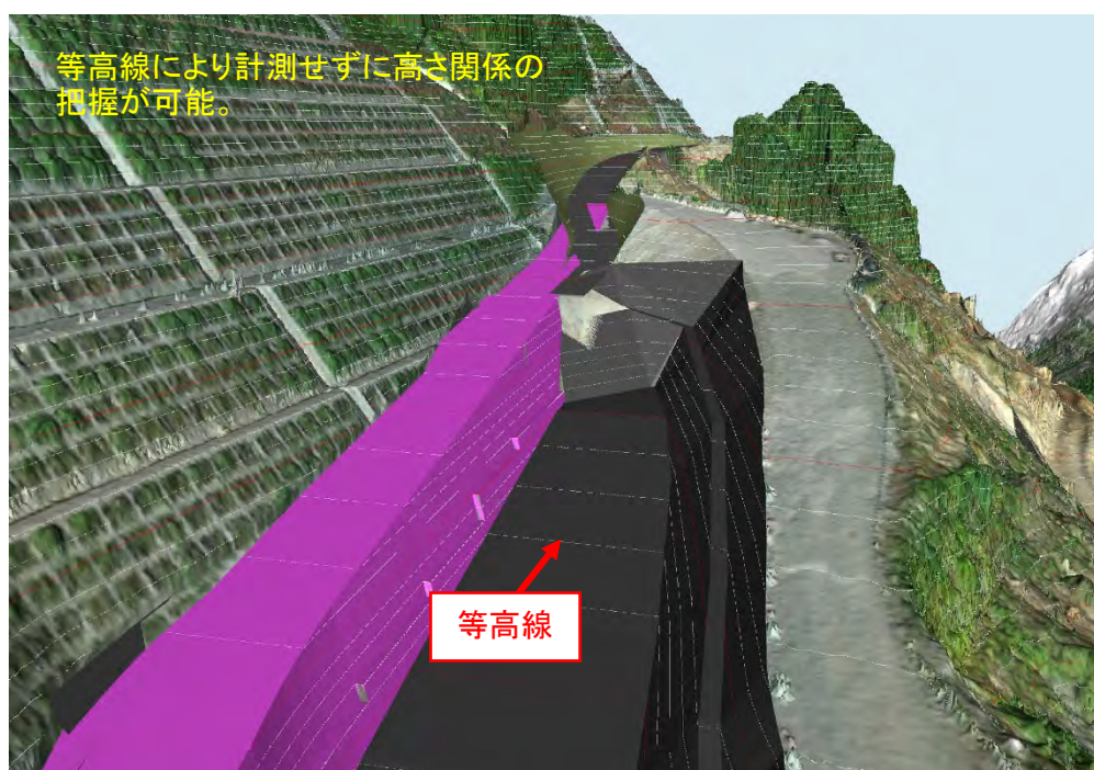
図 2.3.2.(5)-2 等高線を表示した 3 次元モデル
