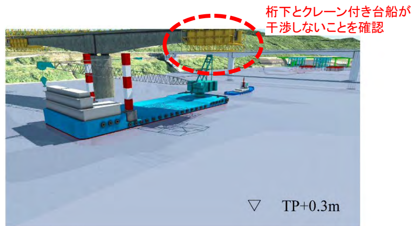
図 2.3.1.(2)-2 上部工干渉シミュレーション図（台船）
