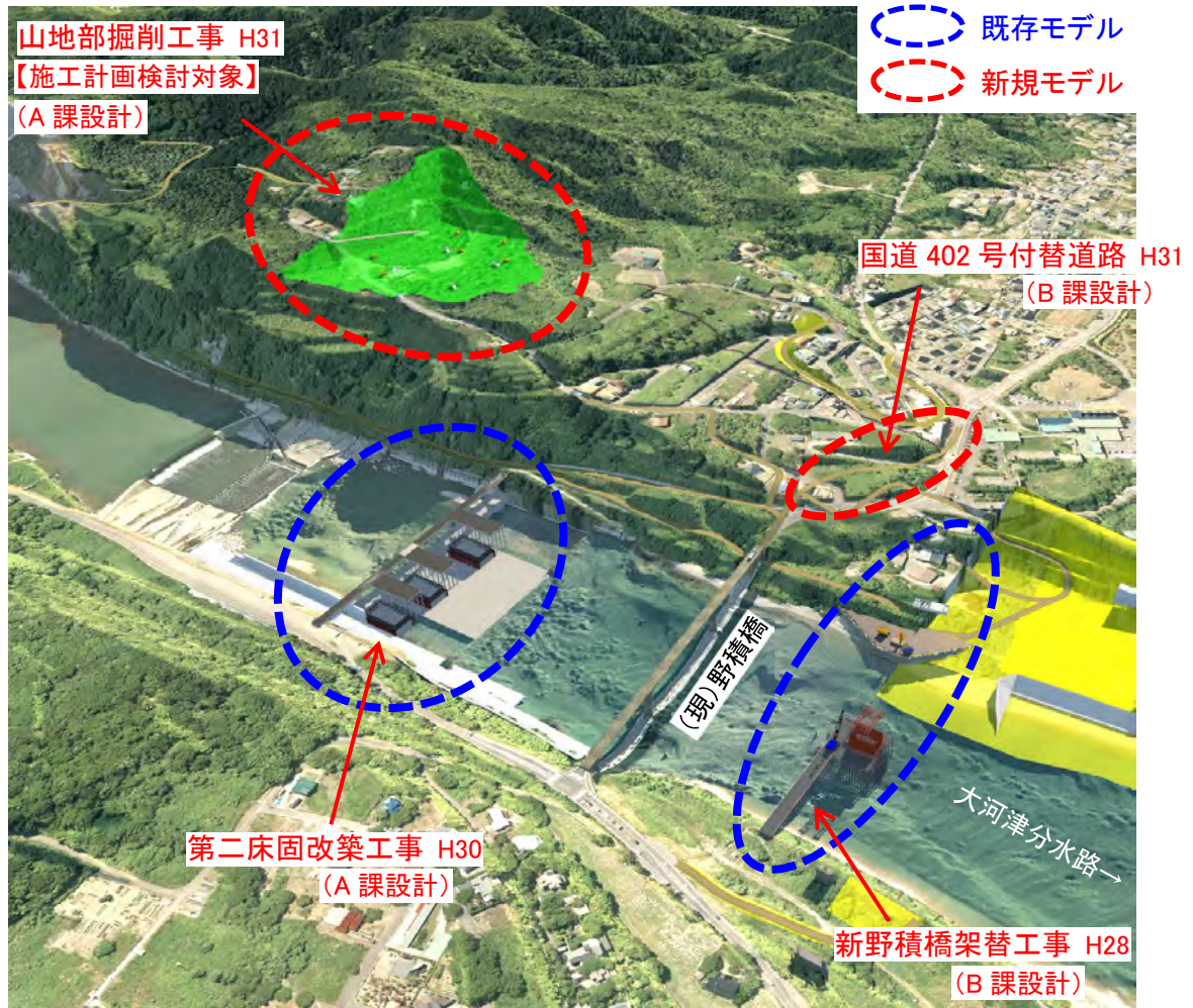
図 2.3.1.(1)-1 複数工事の進捗を考慮した施工計画の検討で活用する検討用モデル
