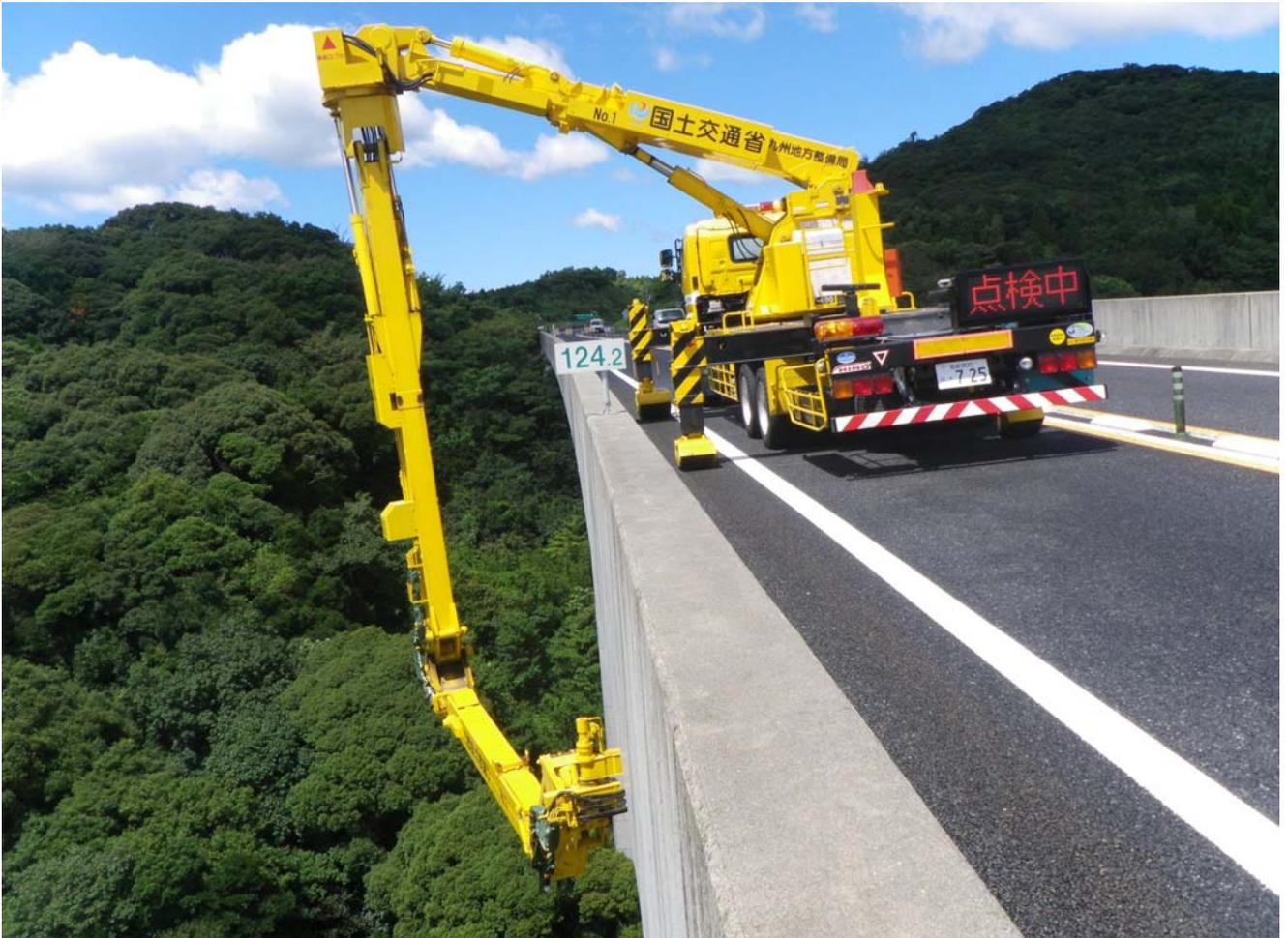
写真 橋梁点検車による工事・点検状況(イメージ)
