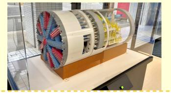
シールドマシンは地中を掘り進み、同時にトンネル 壁面の組み立ても行っていく機械です。
