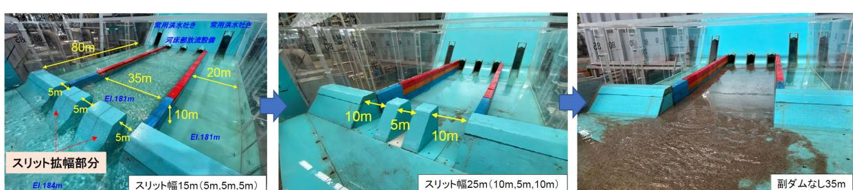
水理模型実験による様々なパターンでの副ダム配置の検討状況
