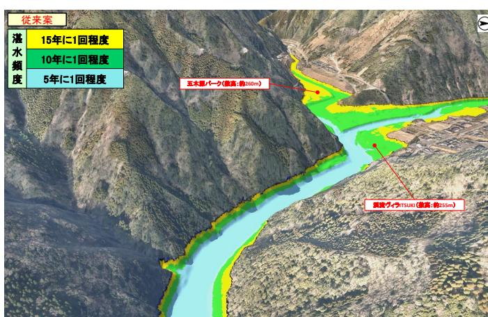
流水型ダムで洪水調節した場合の224洪水実績による貯水範囲(頭地地区付近)
