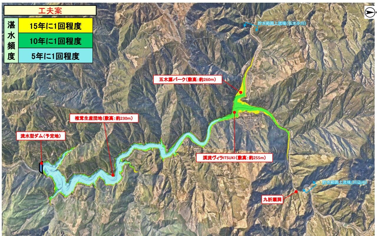
流水型ダムで洪水調節した場合の224洪水実績による貯水範囲(全景)
