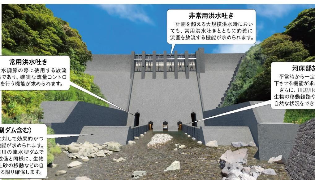
川辺川の流水型ダムのイメージ（ダム下流水面付近から望む）※本イメージは、現時点の設計案に基づき作成しており、今後変更の可能性があります。
