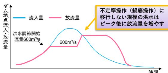
不定率操作(鍋底操作)に移行しない場合の操作イメージ図
