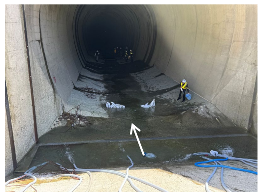
実験 1 回目の状況 (サイフォンホースによる導水)
