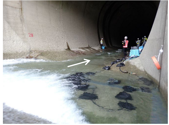
実験 2 回目の状況（大型土のうによる導水）
