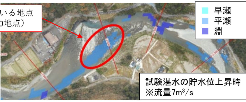
試験湛水の貯水位上昇時を想定した場合の計算結果
