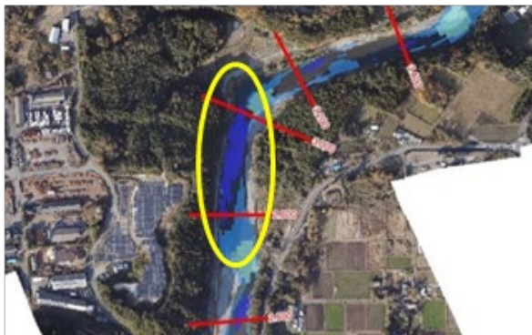
ダム建設後(ダムあり)※ 30m³/s計算結果
