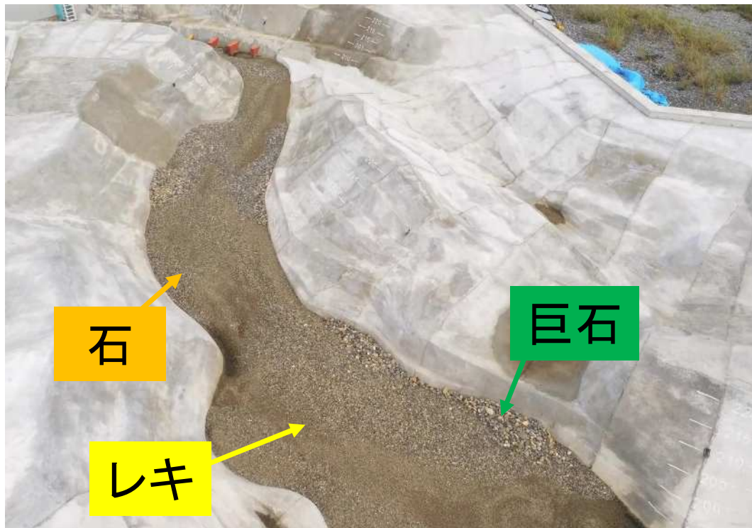
現地を模した、粒径の異なる3種類の実験土砂を敷設
