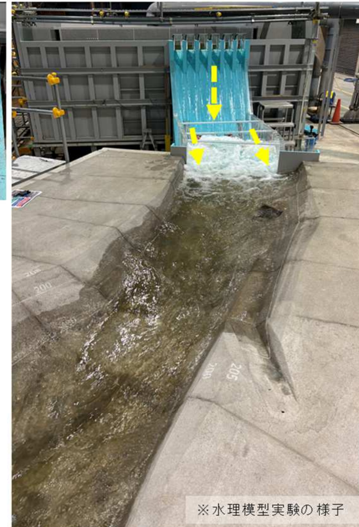
異常洪水時防災操作
