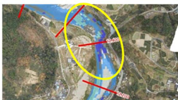
※図は30m<sup>3</sup>/s時の平面二次元河床変動解析計算結果を示す
