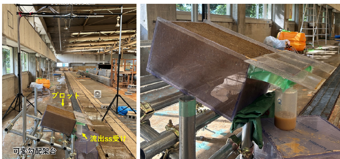
図 2-10 人工降雨装置による室内散水実験の状況
