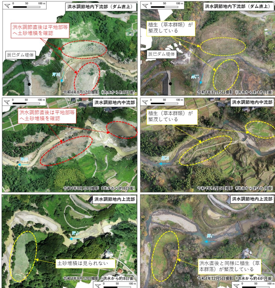
図 2-7 既往流水型ダム（辰巳ダム）の洪水直後（左）と洪水から約4ヵ月後（右）のダム洪水調節地内土砂堆積状況写真
