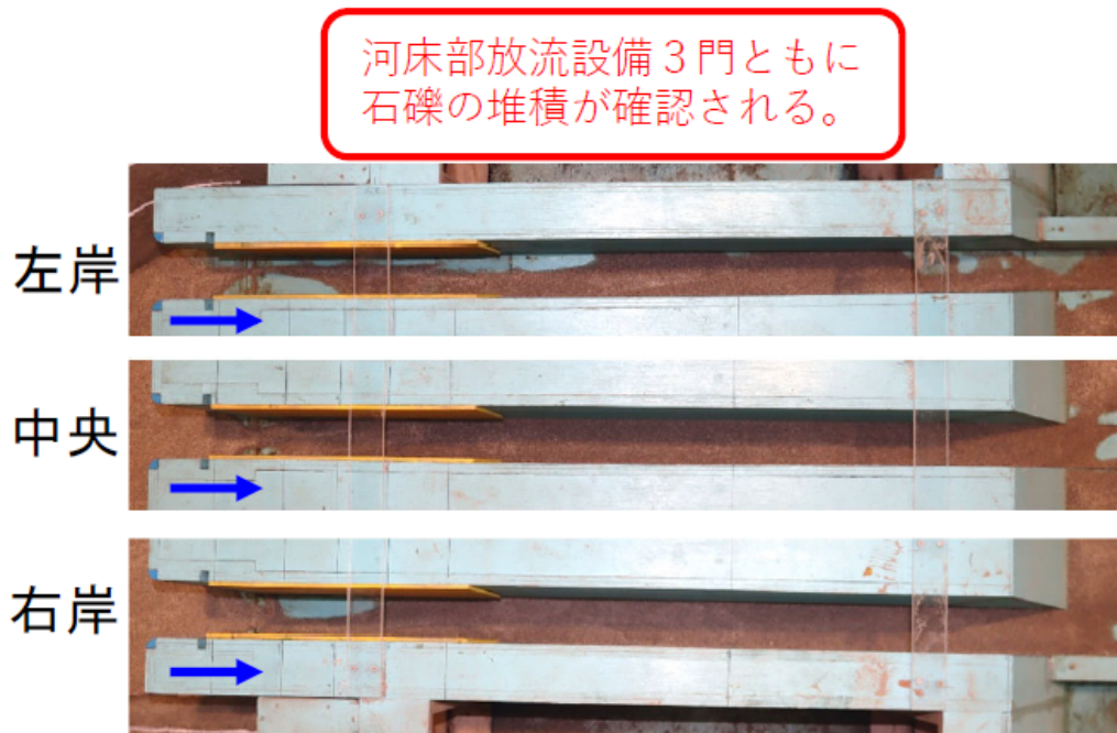
図 2-11 左岸・中央 2 門の敷高を下げたときの石礫の堆積状況
