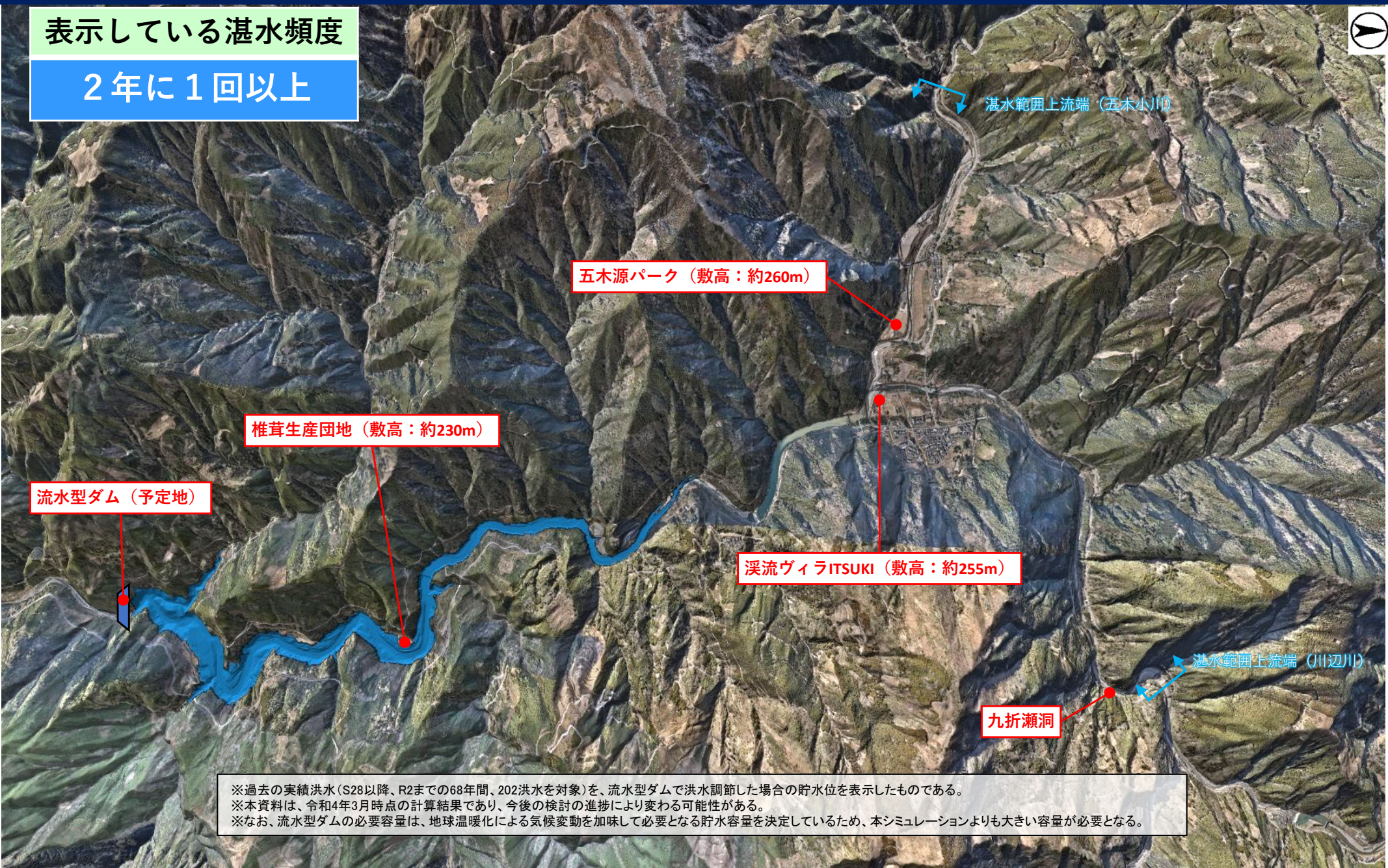
流水型ダムで洪水調節した場合の202洪水実績による湛水範囲【湛水頻度：2年に1回以上】(全景)
