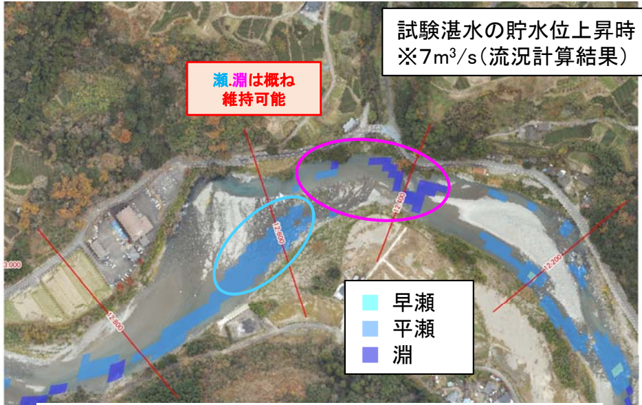
河川流況計算による流量 7\text{m}^3/\text{s} 時の瀬・淵判読結果(晴山地点)
