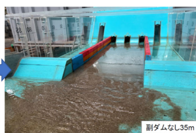
水理模型実験による様々なパターンでの副ダム配置の検討状況
