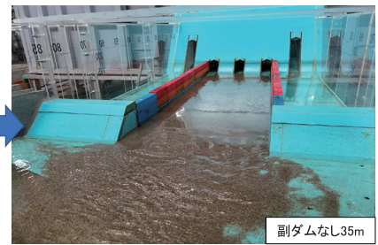
減勢工内に隔壁を設置した場合の実験の様子
