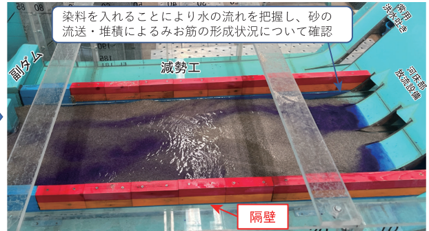
・減勢工内に隔壁を設置したことにより、減勢工内の水や石礫の流れが分散せず、みお筋が形成しやすくなるとともに循環流の発生が解消されたことを確認した
