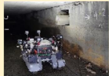
**非破壊検査**：作業の効率化
