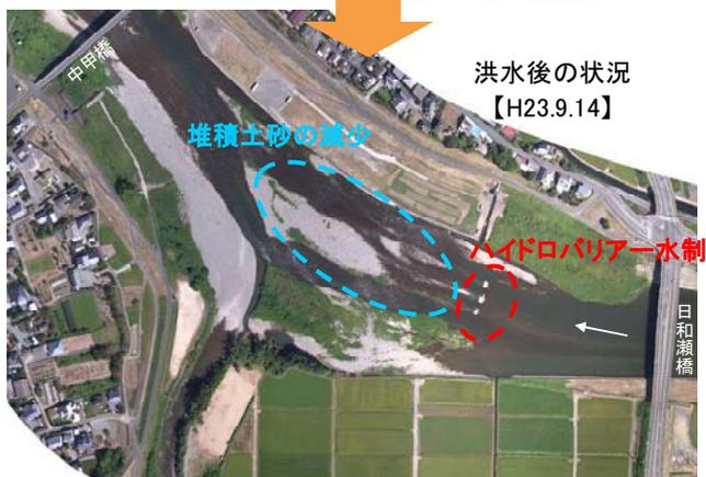
写真 4.3.1 土砂堆積部の河道管理
