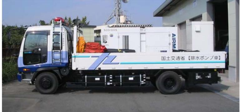
写真 4.3.18 緊急内水対策車（排水ポンプ車）
