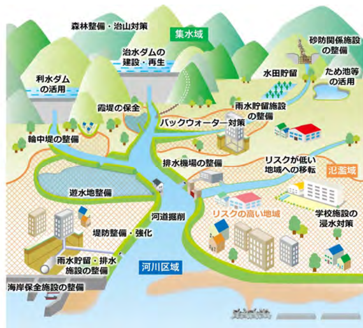
図 5.9-1 流域治水の施策イメージ図
