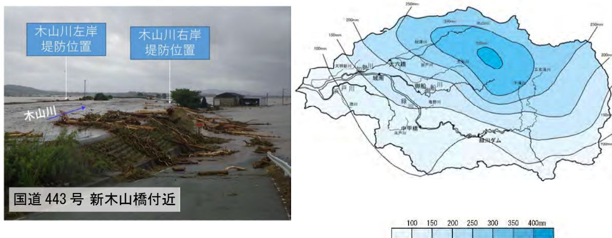
図 1.2-12 緑川流域の等雨量線図 (R5 年 7 月洪水、12 時間雨量)
