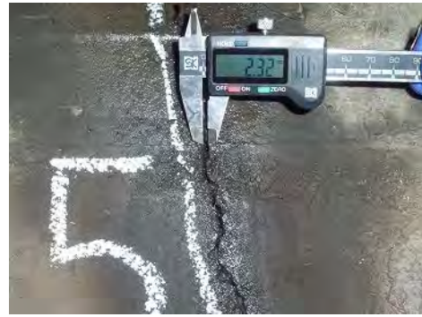
写真 2.1-13 樋管のクラック発生状況
