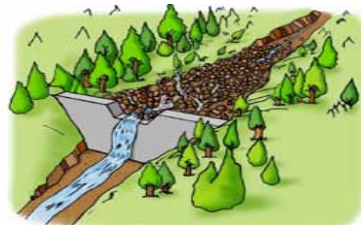
不透過型砂防堰堤
