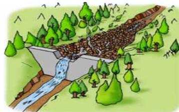
不透過型砂防堰堤
