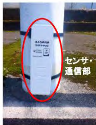
設置予定の浸水センサ
