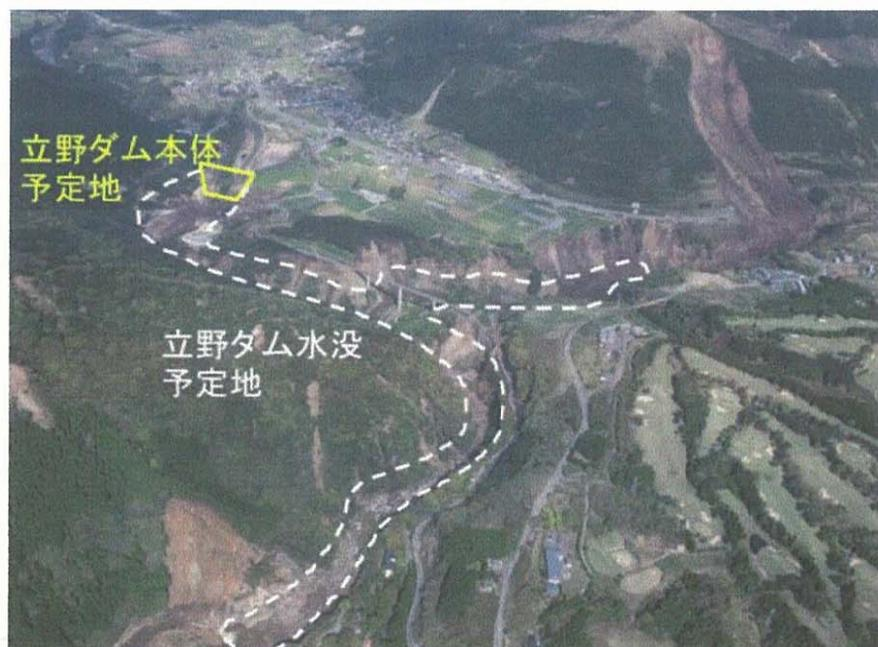
熊本地震後の立野ダム水没予定地。大半が土砂崩壊をしている。
