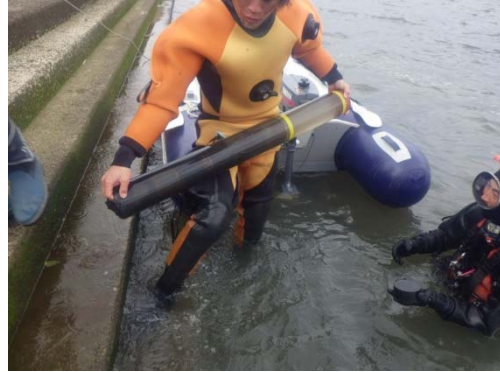
写真 5.2.2 河床材料調査
