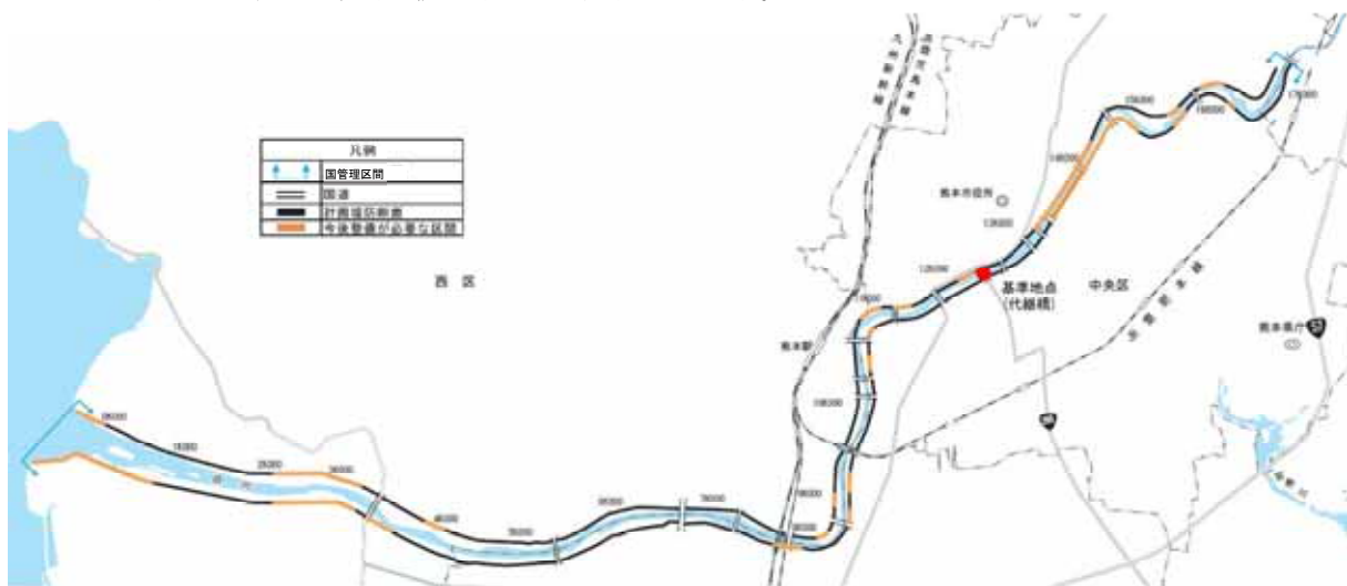
図 2.1.3 国管理区間における堤防整備図
