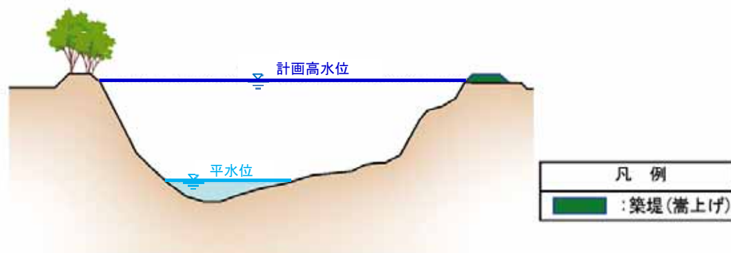
図 5.1.7 中流ブロックにおける築堤の概要図
