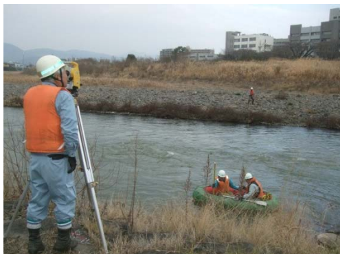
写真 5.2.1 河道の横断測量
