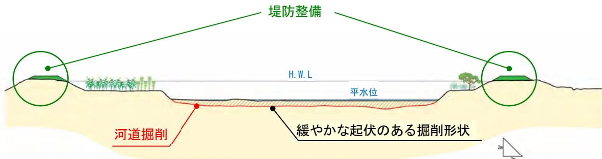
図 4.2-11 整備イメージ図（浜戸川 8k000 付近）
