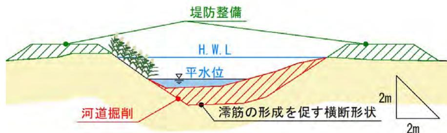
図 4.2-18 整備イメージ図（千滝川 10k600 付近）
