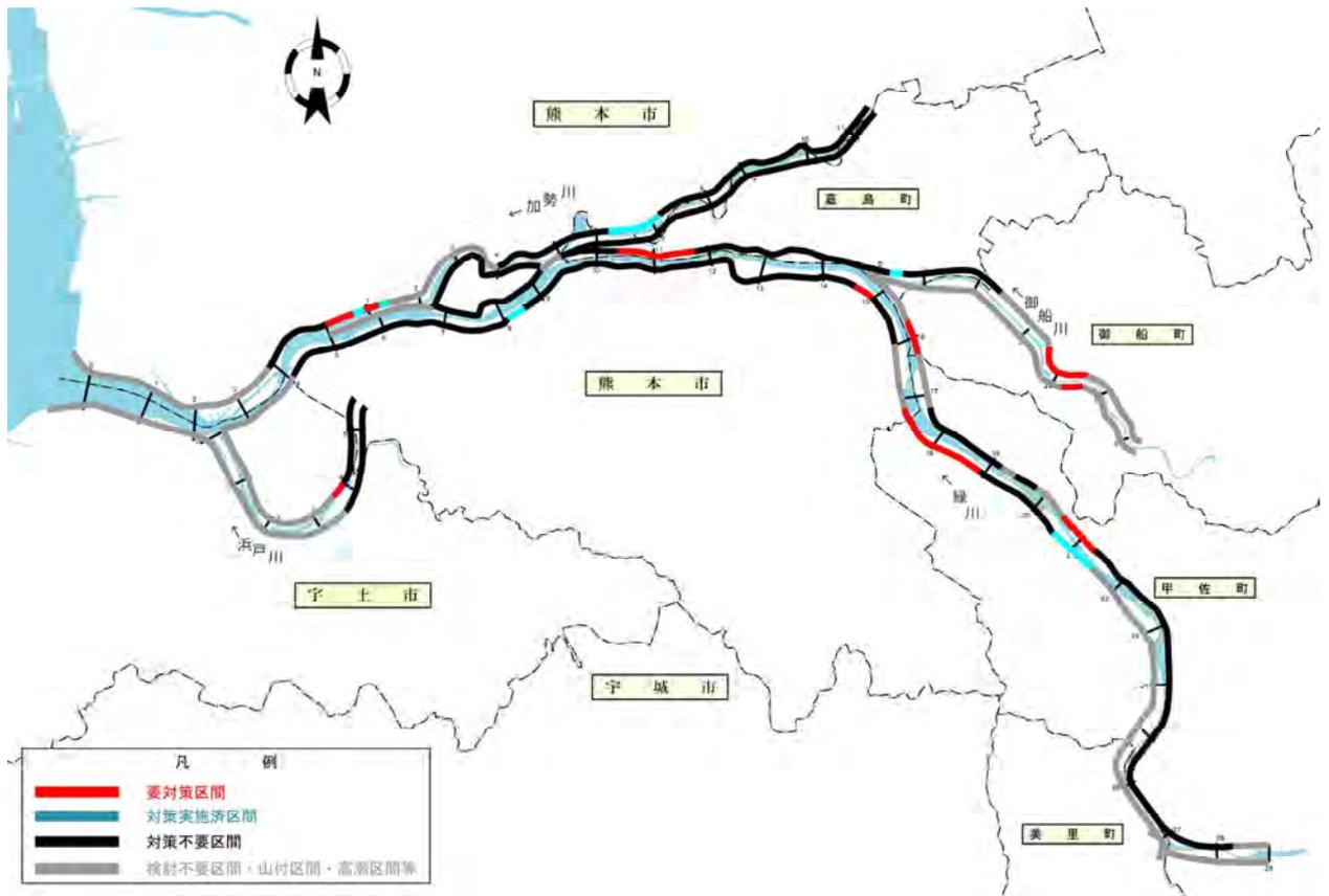
図 2.1-3 堤防詳細点検結果
