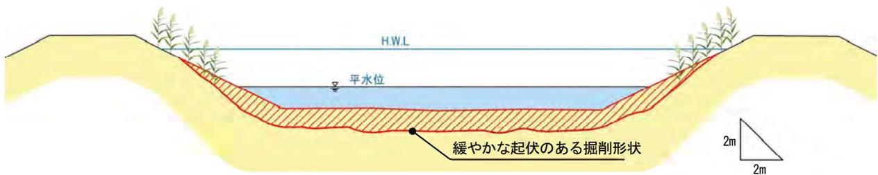
図 4.2-10 整備イメージ図（天明新川 10k200 付近）
