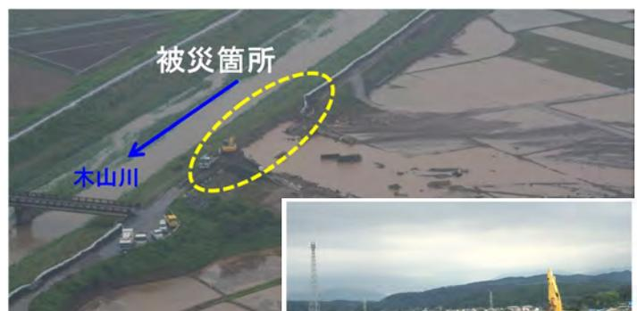
木山川では 6 月 20 日の出水により熊本地震の被災で緩んだ堤防が**損傷**したが、緊急復旧に着手し 24 日には応急対策工事を完成。
