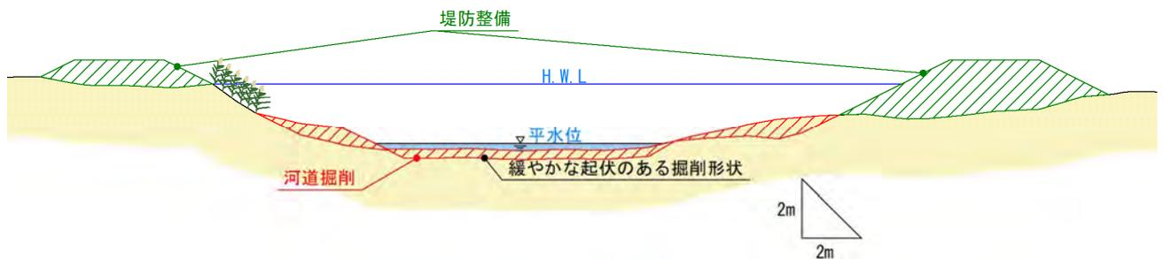
図 4.2-19 整備イメージ図（五老滝川 3k000 付近）
