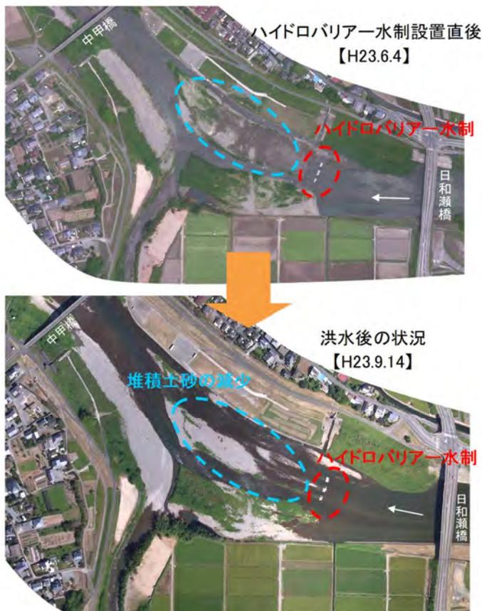
写真 4.3-14 土砂堆積部の河道管理
